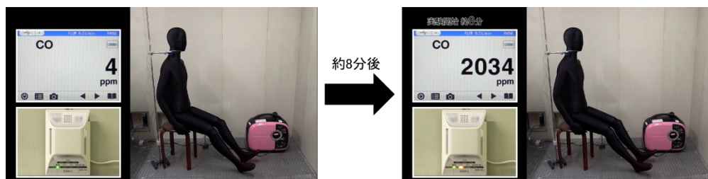
室内で携帯発電機を使用した際の一酸化炭素中毒（提供：NITE）
