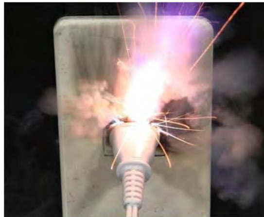
【NITEの再現実験】 トラッキング現象による発火
