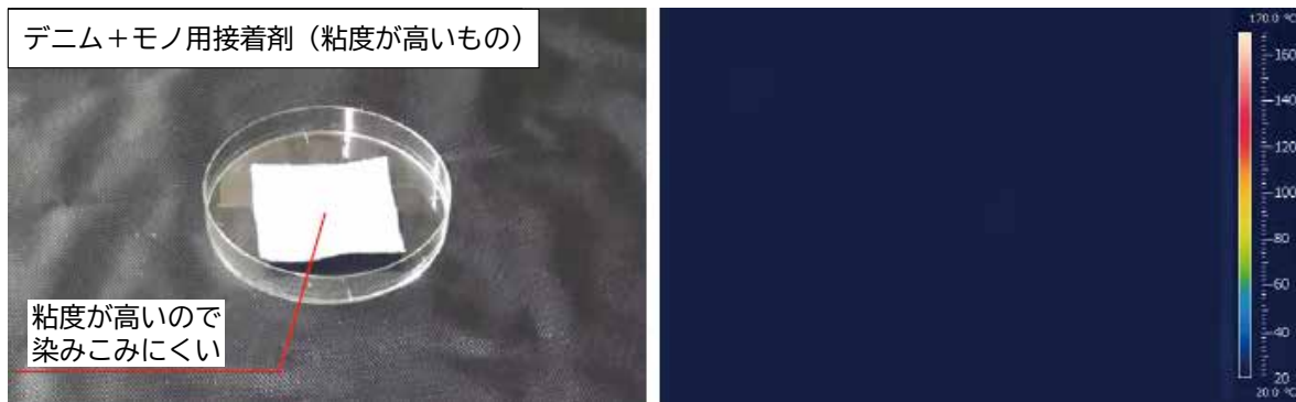
図表 I-1-2-17 粘度が高い接着剤で発熱しない様子（左は外観、右は熱画像装置）
