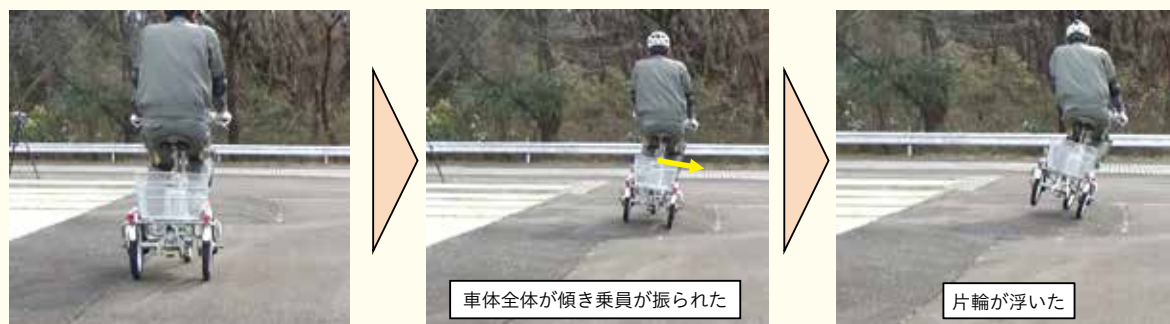
図表I-1-2-11 傾斜面に侵入する様子（スイング機構を固定した場合、進入速度 6 km/h）
