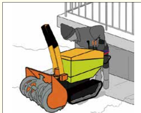
除雪機と壁等に挟まれる事故
