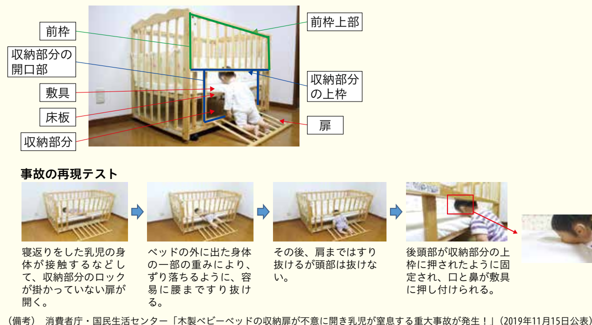
図表I-1-1-5 木製ベビーベッドでの事故発生時のイメージと事故の再現テスト
