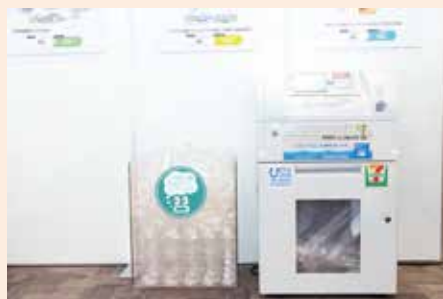
店頭に設置されたペットボトル減容回収機
