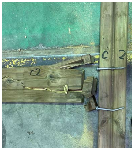
写真 28 梁接合部の荷重試験
