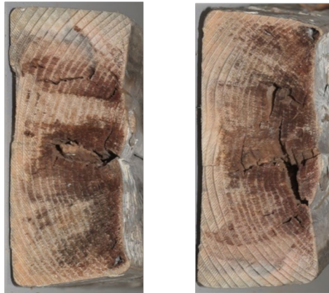
写真 14 床受材の切断面（写真左右は同一部材） （約 1 年 3 か月後）
