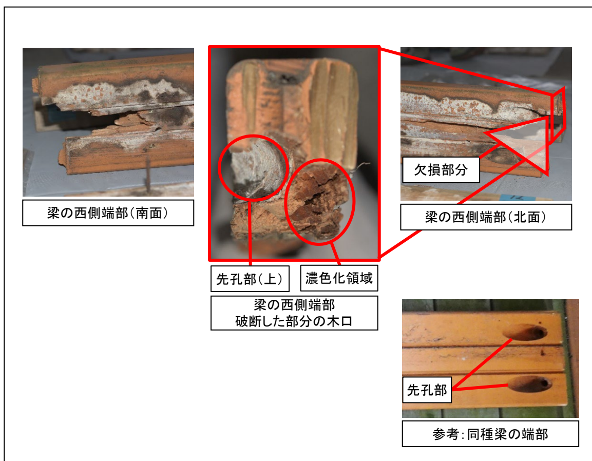
写真9 梁の西側端部木口の様子
