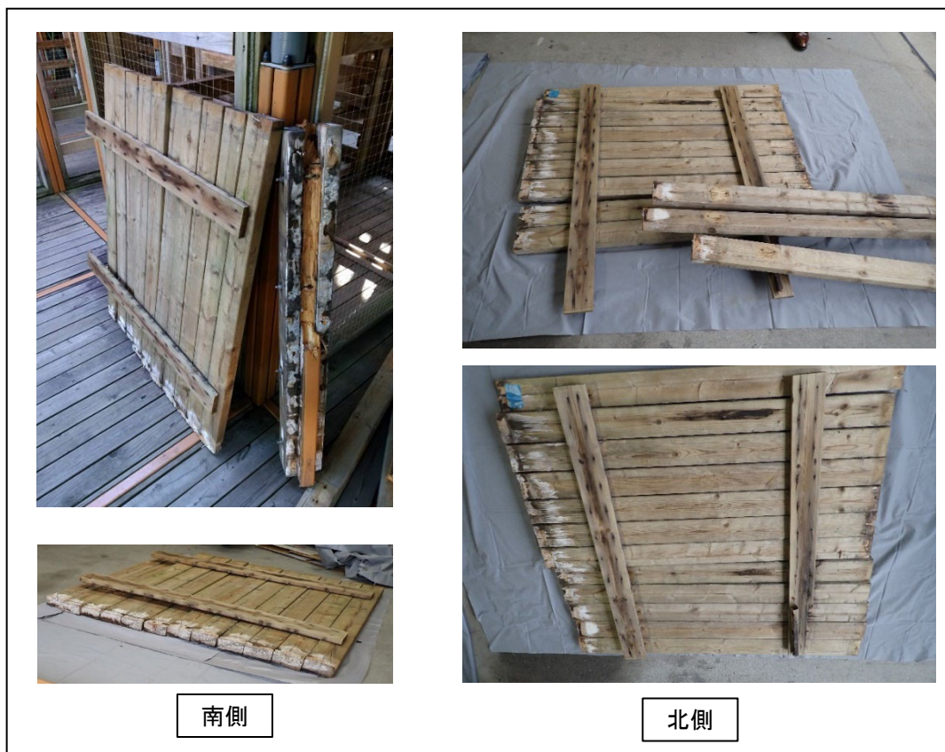
写真 18 落下した床板
