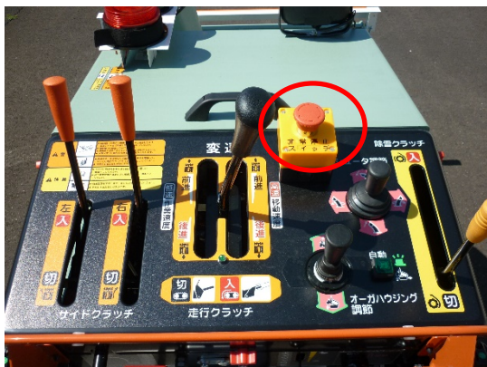
図 2-7 非常停止ボタン
