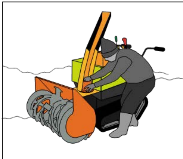
図 10 投雪口に手を突っ込み負傷する事故 （素手で雪を取り除くイメージ）
