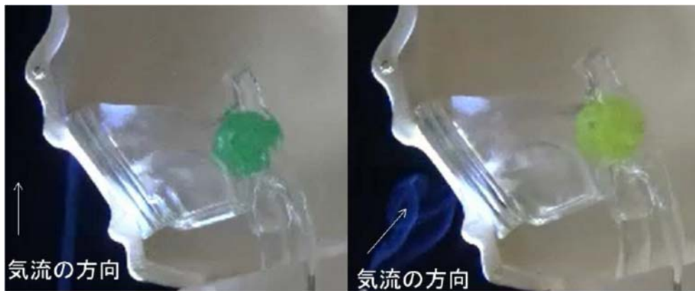
写真7 ファントム実験画像（左：穴なしボール、右：2mm穴ボール）
