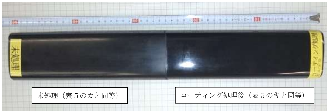
図8 本件エスカレーターのハンドレールと同型品へのコーティング前後外観
