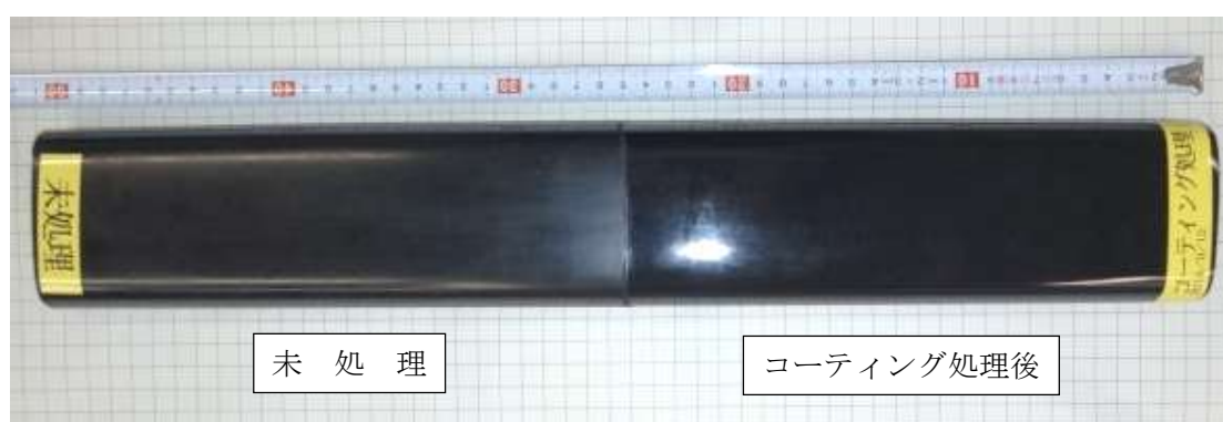
図 1-2 本件同等のハンドレール「Dポ」へのコーティング加工前後の外観
