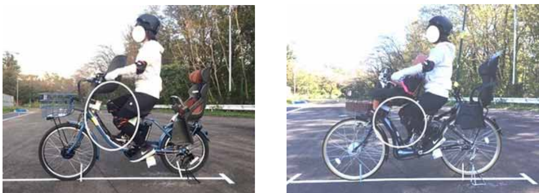
写真 18 サドルと前座席の位置関係（左：検体A 1、右：検体A 4） ※共にサドルー前座席間距離が小さい。ただし、検体A 4と比較して、検体A 1は前座席が高く運転者の足元が広く、運転席のスペースに余裕がある（白丸部）。
