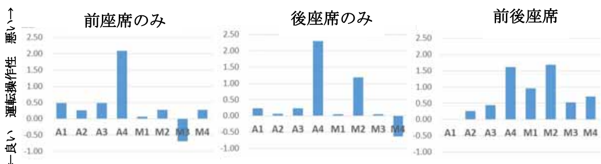
図 54 ダミー人形乗せ位置別の評価結果（主観評価：段差 5 cm）
