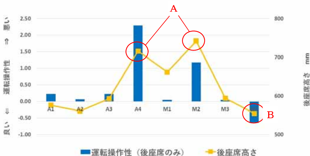
図 58 運転操作性と後座席の高さの関係 (ダミー人形後座席のみ)
