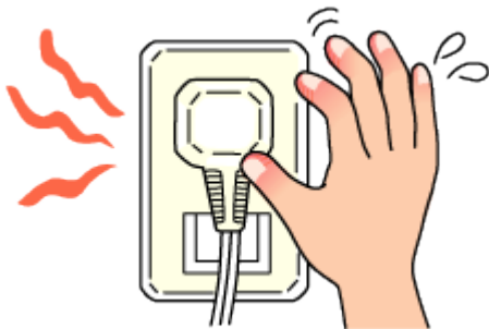
電源コードやプラグが異常に熱い。
