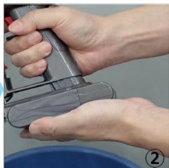
②バッテリーを掃除機に装着
